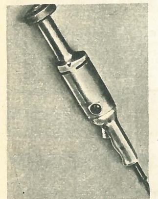
Электрический шабер (фото 3) весом 5,5 кг изготавливается на заводе электротехнических изделий.
