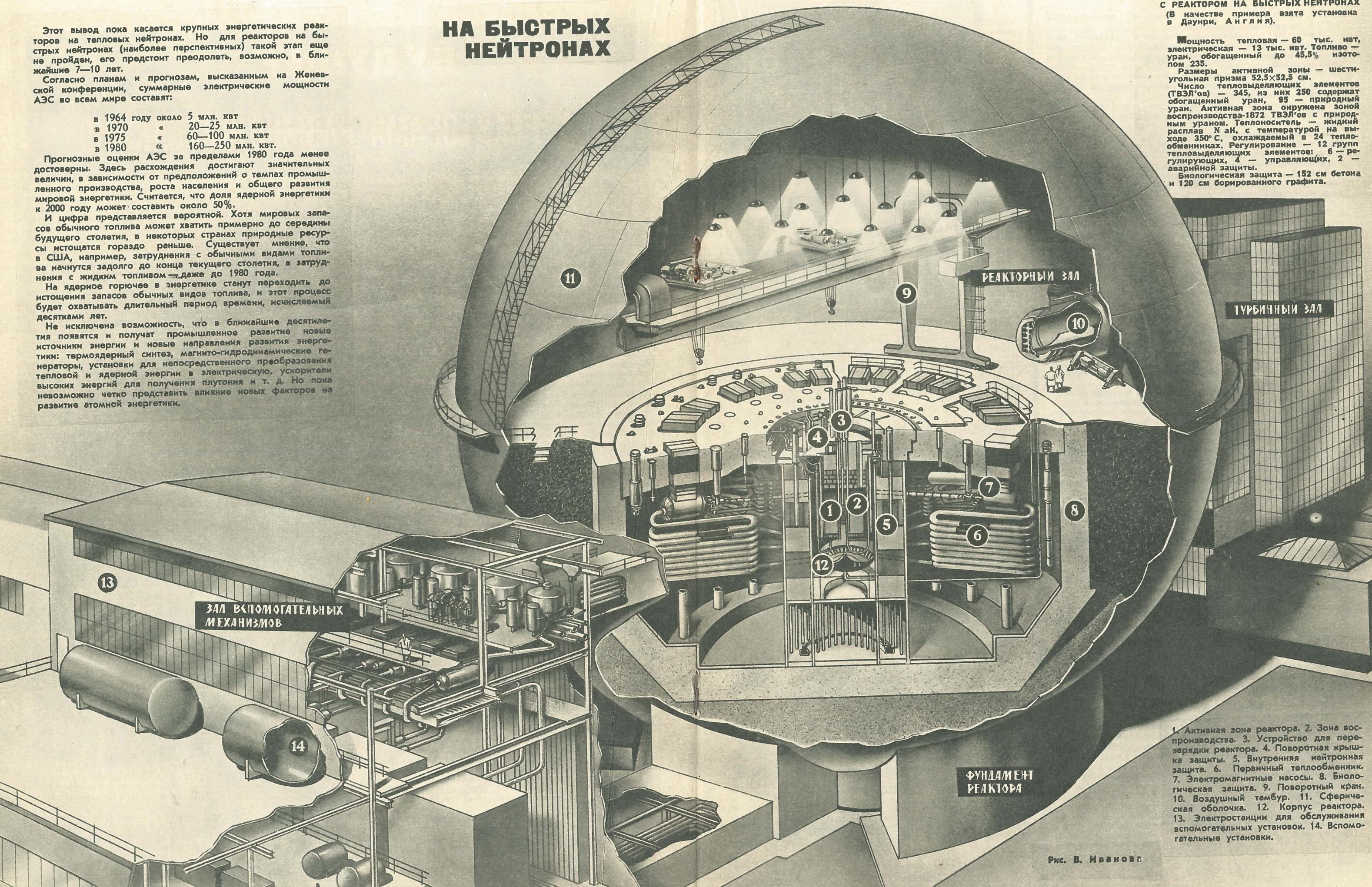
1. Активная зона реактора. 2. Зона воспроизведения. 3. Устройство для перевозки реактора. 4. Поворотная крышка защиты. 5. Внутренняя нейтронная защита. 6. Первичный теплообменник. 7. Электромагнитные насосы. 8. Биологическая защита. 9. Поворотный кран. 10. Воздушный тамбур. 11. Сферическая оболочка. 12. Корпус реактора. 13. Электростанции для обслуживания вспомогательных установок. 14. Вспомогательные установки.
