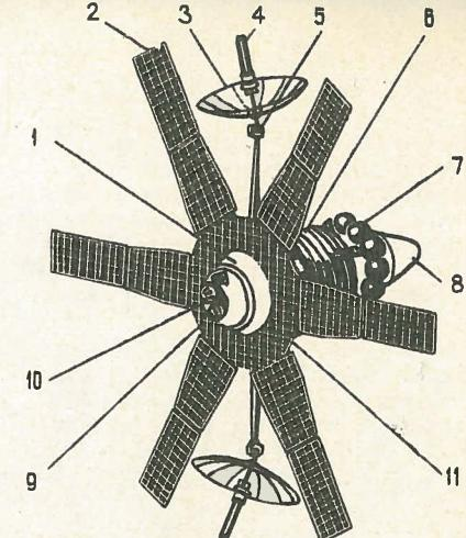
СПУТНИК «МОЛНИЯ-1»: 1 — герметичный корпус, 2 — солнечная батарея, 3 — остронаправленная антенна, 4 — датчик ориентации, 5 — антенный привод, 6 — радиатор-холодильник, 7 — запас рабочего тела для проведения микрокоррекции, 8 — корректирующая двигательная установка, 9 — датчик ориентации для проведения коррекции, 10 — датчик солнечной ориентации, 11 — панель-нагреватель.
