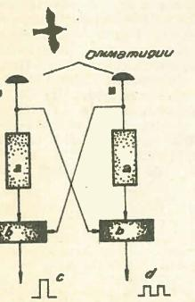
а) задержка, б) суммирующий каскад, в) импульс с двойной амплитудой, г) два импульса с одинарной амплитудой.
