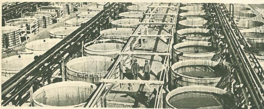
Воды, в которых содержится йод, обычно связаны с нефтяными месторождениями. Извлекаются они на поверхности вместе с нефтью. В специальных отстойниках вода отделяется от нефти и затем по каналам или трубопроводам поступает в адсорбционные хранилища йодистых заводов. На снимке — отделение адсорбции Бакинского йодового завода.
