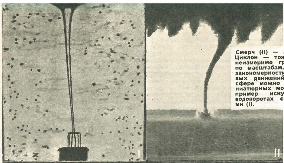
Смерч (II) — это вихрь. Циклон — тоже, только неизмеримо грандиознее по масштабам. Изучать закономерности вихревых движений в атмосфере можно и на миниатюрных моделях, например искусственных водоворотах с воронками (I).
