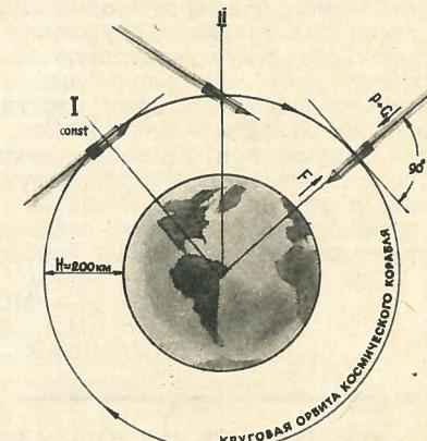
На схеме: I. Положение космического корабля вначале разгона по орбите — после свободного полета с первой космической скоростью. II. Промежуточный момент разгона. III. Конечный момент разгона: корабль развил максимальную скорость, сила тяги двигателя направлена к центру Земли и уравновешивает центробежную силу.
