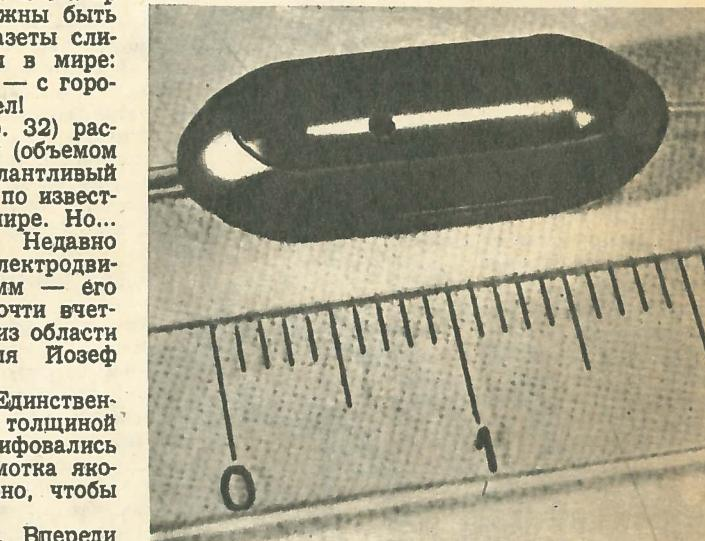
Диагностическая капсула имеет в длину 2,1 см, в ширину и высоту — 0,7 см.
