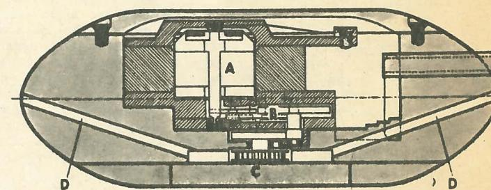
Внутреннее устройство миниатюрного зонда: А — моторчик; В — приводной механизм; С — зубчатка, упирающаяся в насечку на нити; D — каналы для направляющей нити.
