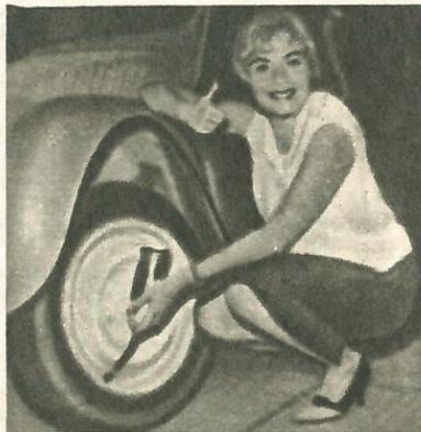
дувает шину. После такого ремонта можно проехать не менее 500 км, а уж потом чинить резину на станции обслуживания (Франция).
