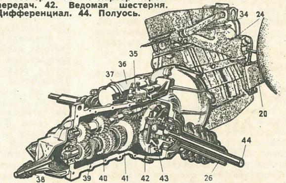
Коробка передач с четырьмя скоростями и задним ходом снабжена так называемой синхронизацией, обеспечивающей быстрое и бесшумное переключение. Полностью автоматизированные линии на новом заводе в Болеславе скоро будут выпускать много таких автомобилей.
