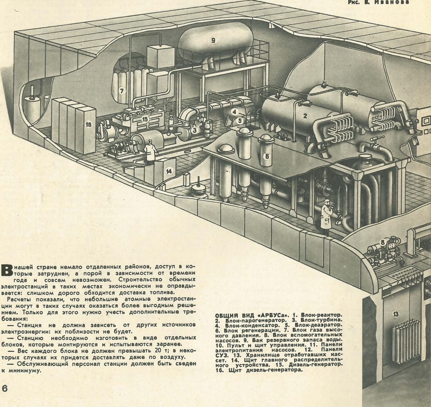
**ОБЩИЙ ВИД «АРБУСа».** 1. Блок-реактор. 2. Блок-парогенератор. 3. Блок-турбина. 4. Блок-конденсатор. 5. Блок-деаэратор. 6. Блок регенерации. 7. Блок газа высокого давления. 8. Блок вспомогательных насосов. 9. Бак резервного запаса воды. 10. Пульт и щит управления. 11. Панели электропитания насосов. 12. Панели СУЗ. 13. Хранилище отработавших кассет. 14. Щит главного распределительного устройства. 15. Дизель-генератор. 16. Щит дизель-генератора.
