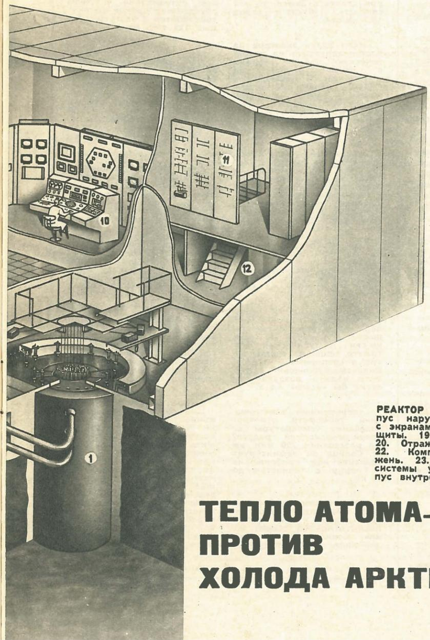
**РЕАКТОР «АРБУСа».** 17. Корпус наружный. 18. Крышка с экранами биологической защиты. 19. Боковые экраны. 20. Отражатель. 21. Кассета. 22. Компенсирующий стержень. 23. Ручной регулятор системы управления. 24. Корпус внутренний.
