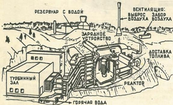
ветственно 200° и 30 атм. 10 мегаватт выделяемой энергии преобразуются в электричество. 55 мегаватт идет на нагревание воды для жителей пригорода Стокгольма — Агеста. Потребитель получает горячую воду в 60° (Швеция).
