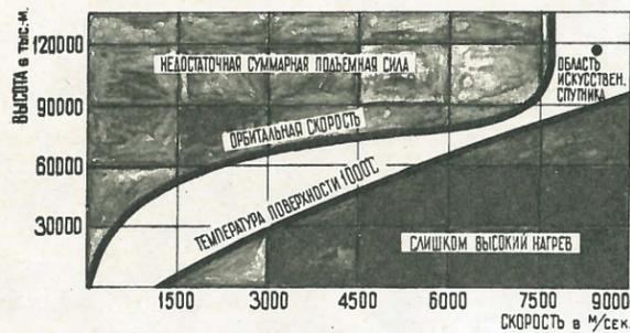
Полетный коридор для гиперзвуковых самолетов лежит между двумя зонами — зоной недостаточной подъемной силы и зоной перегрева обшивки.
