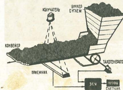
ленты, нетрудно подсчитать количество угля, прошедшего по конвейеру за определенный промежуток времени. Подсчет выполняет электронный счетчик, к выходу которого подключен обычный электрический счетчик. Если скорость движения конвейера непостоянна, то на электронный счетчик попадает дополнительный корректирующий импульс от генератора оборотов, соединенного с приводом конвейера.
