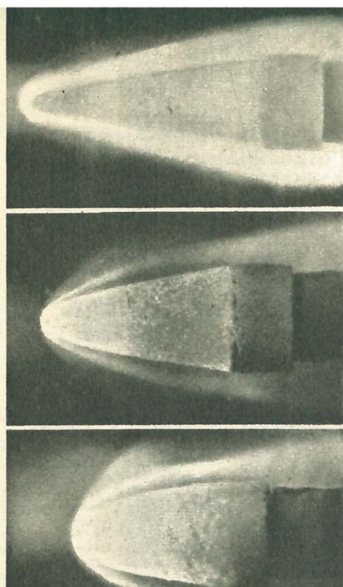
В заголовке — конус из тefлона в плазменной испытательной трубе. Интервал времени между кадрами — 10 сек. Температура — около 10000°С.
