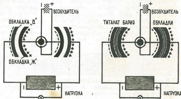
Так может быть построена простейшая модель емкостного генератора для работы в космосе. На помощь пришла керамика.
