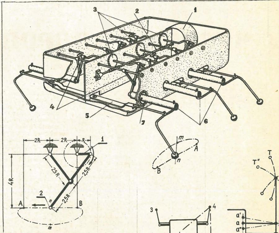
Шагающую машину такого типа легко герметизировать, надев на все шарниры металлические или пластмассовые гофрированные чехлы. Тогда она сможет двигаться по дну моря, по поверхности Луны и планет.
