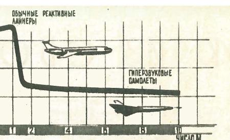
Так зависит аэродинамическое качество крыла (отношение подъемной силы к силе лобового сопротивления) от скорости полета. За звуковым барьером из-за возникновения ударных волн качество резко падает.
