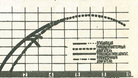
А так изменяется термический КПД воздушно-реактивных двигателей от скорости полета. Интересно, что при гиперзвуковых скоростях единственно приемлемым оказывается прямоточный двигатель.
