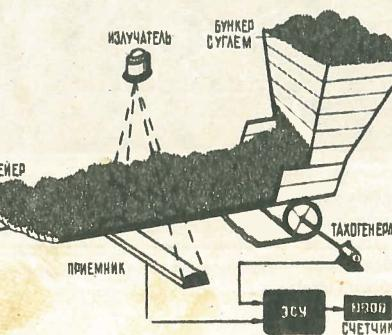
**С** ПОМОЦЬЮ РАДИОАКТИВНОГО излучения кобальта-60 производится измерение количества угля, проходящего по конвейеру. Узкий пучок гамма-лучей (см. рис.) пронизывает слой угля по всей ширине конвейерной ленты.
