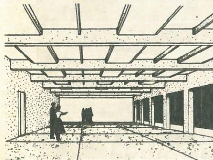
ких марок и высококачественная сталь с предварительным натяжением позволяют весьма эффективно применять безраскосные фермы для пролетов от 18 до 24 м. В результате новый тип здания с безраскосными фермами и использованным межферменным этажом стоит (из расчета на 1 кв. м полезной площади здания) на 15—20% дешевле, является более «гибким» и прогрессивным. А время строительства сокращается на 20—25%.
