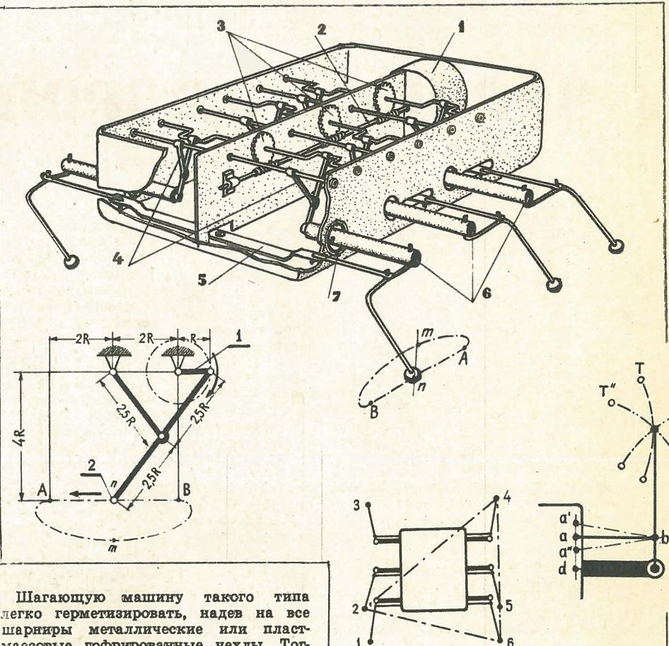
Шагающую машину такого типа легко герметизировать, надев на все шарниры металлические или пластмассовые гофрированные чехлы. Тогда она сможет двигаться по дну моря, по поверхности Луны и планет.
