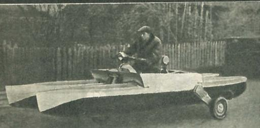
На обложке — автомобиль-амфибия А. ГОРШКОВА. Здесь, на фото, тоже амфибия. Но машина А. Горшкова — «плавающая автомобиль», а это — «ездящая лодка». Авторы конструкции Е. РЫЧКОВ, Л. МОХОВ и В. МАЛИКОВ назвали ее «катамаран-вездеход». Скорость на воде до 12 км/час, на суше — 50 км/час. Длина катамарана — 5 м, водоизмещение — 1500 кг, вес — 160 кг. Двигатель — «ИЖ-49».
