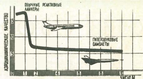
Так зависит аэродинамическое качество крыла (отношение подъемной силы к силе лобового сопротивления) от скорости полета. За звуковым барьером из-за возникновения ударных волн качество резко падает.
