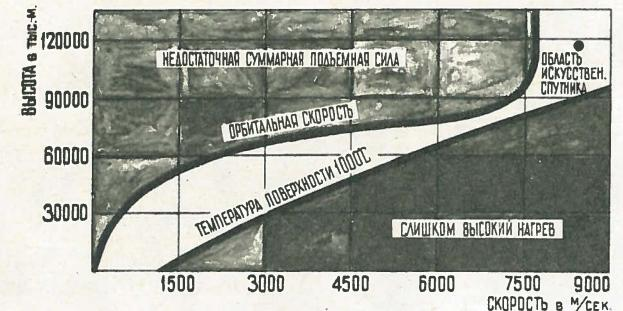
Полетный коридор для гиперзвуковых самолетов лежит между двумя зонами — зоной недостаточной подъемной силы и зоной перегрева обшивки.
