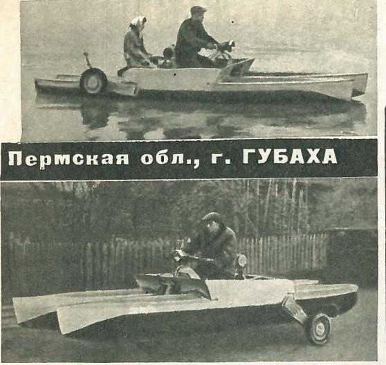
На обложке — автомобиль-амфибия А. ГОРШКОВА. Здесь, на фото, тоже амфибия. Но машина А. Горшкова — «плывающий автомобиль», а это — «ездящая лодка». Авторы конструкции Е. РЫЧКОВ, Л. МОХОВ и В. МАЛИКОВ назвали ее «катамаран-вездеход». Скорость на воде до 12 км/час, на суше — 50 км/час. Длина катамарана — 5 м, водоизмещение — 1 500 кг, вес — 160 кг. Двигатель — «ИЖ-49».
