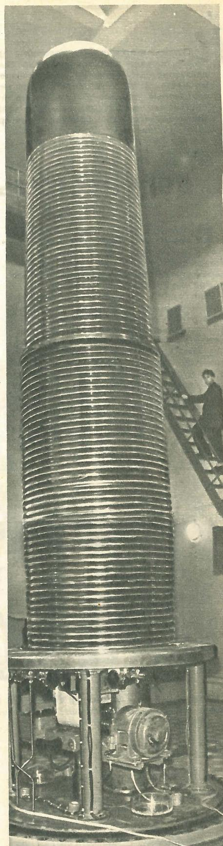
**В ДУБНЕ ПОСТРОЕН ЕЩЕ** один ускоритель — электростатический генератор (на снимке он сфотографирован без защитного кожуха) на энергию 5 млн. электроновольт.
