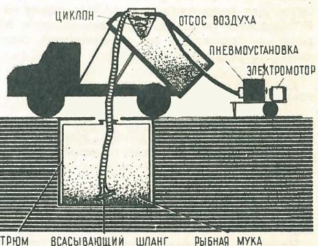
Старший инженер Мурманского рыбного порта Г. А. Ляпин разработал пневматическую всасывающую установку. Шланг длиной 20 м и диаметром 150 мм опускается в трюм, включается воздушная дувка, и мука отсыпается в цистерну автомашин. Воздух, очищенный при помощи циклонов, выбрасывается наружу. 3-тонная цистерна заполняется в течение 12 мин., мощность электродвигателя пневмоустановки 22 квт.
