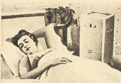
Этот переносный аппарат, сконструированный в Америке, пропускает комнатный воздух между заряженными пластинами, на которые осаждаются частицы пыли, дыма и т. п. Изобретатель предполагает организовать массовый выпуск таких аппаратов для продажи.
