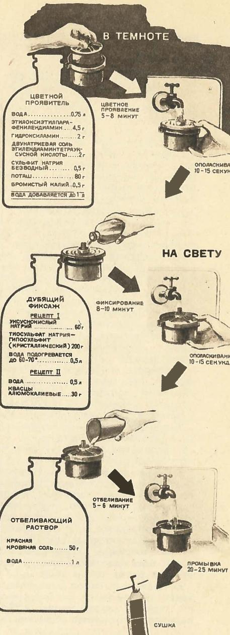
Процесс обработки цветной пленки по упрощенному способу. Там же операции и в той же последовательности применяются и при обработке цветной фотобумаги.
