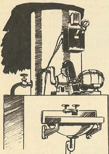
Водокачка рассчитана на перекачку нескольких тысяч литров воды в сутки. Ее средняя производительность достигает 25 л в минуту. Автоматический центробежный насос установки работает от электродвигателя, питающегося то-
