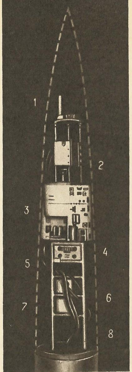
Головка ракеты с аппаратурой для исследования верхних слоев атмосферы. Здесь расположены: механизм сброса аппаратуры при входе в плотные слои атмосферы 1, спектрофографы 2, источник питания спектрофографов 3, кислотные аккумуляторы 4, реле времени 5, распределительная коробка 6, приемник сигнала сброса 7, импульсный передатчик 8.
