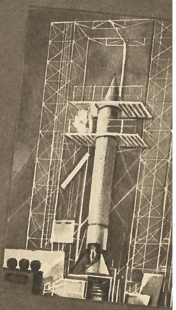
Более поздняя конструкция — американская ракета «Викинг № 9» развивает максимальную скорость около 2 тыс. м в секунду и достигает высот порядка 200 км. «Викинг № 9» поднимает 342 кг полезного груза и весит на старте 5,5 т, из которых 3,5 т приходится на топливо.
