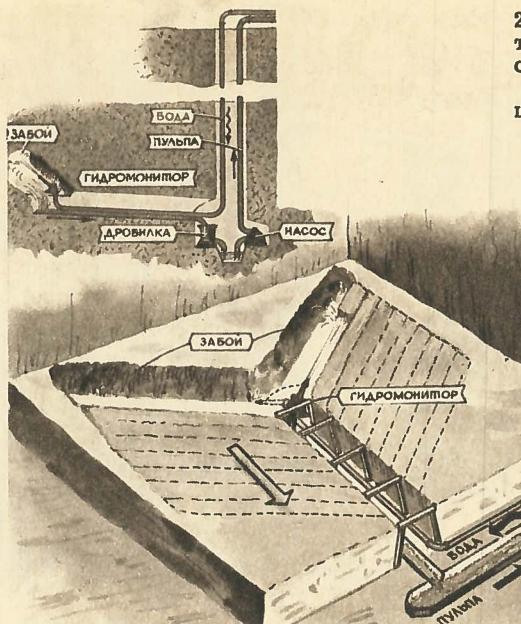
Схема угледобычи способом гидромеханизации.
