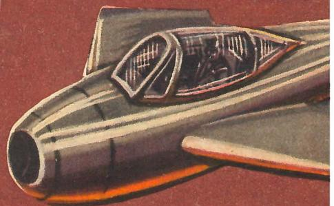
На высоту свыше 20 км поднимаются самолеты, оборудованные герметичными кабинами.
