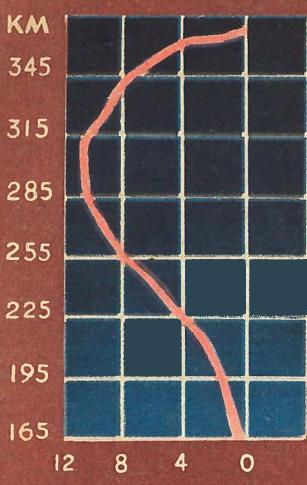
Изменение концентрации ионов с высотой, по данным ракетных подъемов.
