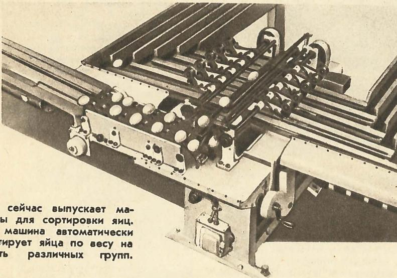
да» сейчас выпускает машины для сортировки яиц. Эта машина автоматически сортирует яйца по весу на шесть различных групп.
