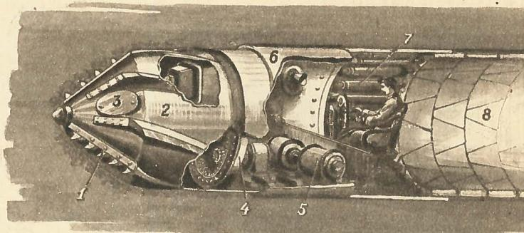
Подземная лодка для коммунальных тоннелей: 1. Бур, разрыхляющий грунт. 2. Шнек, транспортирующий грунт. 3. Люк для выхода вперед. 4. Венцовальная шестерня с подъемником. 5. Электродвигатель и привод бура. 6. Домкраты, уплотняющие грунт. 7. Пульт управления. 8. Блокная отделка тоннеля.
