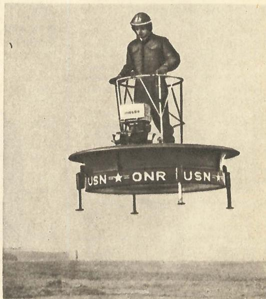
Нерешенной пока остается проблема аварийного спуска. Ведь в случае отказа одного из моторов аппарат упадет на землю, как камень. Если проблема аварийного спуска будет решена окончательно, то полеты на «сковородке» из дома на службу и обратно станут столь же возможными, как поездки на мотоцикле.
