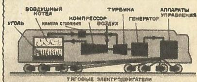
На этом тепловозе установлен четырехтактный шестицилиндровый двигатель внутреннего сгорания мощностью 1000 л. с. при 740 об/мин. Наддув — подача в цилиндры предварительно сжатого воздуха — обеспечивает принудительную продувку в конце выхлопа и полную зарядку свежим воздухом. Для работы воздухоподогревателя, подающей сжатый воздух, используется энергия выхлопных газов. Применение наддува обеспечивает повышение мощности двигателя до 40—50%. Оно улучшает охлаждение поршней.
