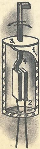
Электронный датчик микрометра представляет собой двухэлектронную лампу — механически управляемый диод. Внутри корпуса лампы 1 находится плоский подогревный катод 2 и параллельный ему плоский анод. Анод укреплен на рычаге 4, проходящем сквозь эластичную мембрану 3.
