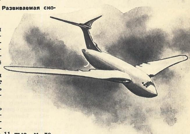
Турбореактивные двигатели этого самолета, развивающего скорость до 1100 км/час вмонтированы в крылья по два с каждой стороны корпуса.
