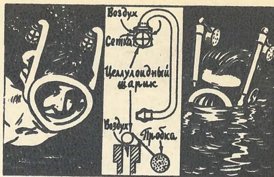
Устройство для плавания под поверхностью воды и кратковременного ныряния в маске с дыхательными трубками («сноркель»). Справа показано два вида устройства дыхательного клапана, предохраняющего маску от проникновения в нее воды при погружении пловца глубже высоты трубок. В одном случае (а) легкий целлулоидный шарик, попадая в воду, поднимается и закрывает отверстие трубки. В другом устройстве (б) закрывание отверстия трубки происходит при всплытии поплавок из пробки.
