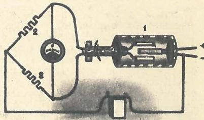
Включение двойного двуханодного датчика в мостовую схему. Двойной датчик 1 образует одну половину мостовой схемы. Вторая половина состоит из двух сопротивлений 2.
