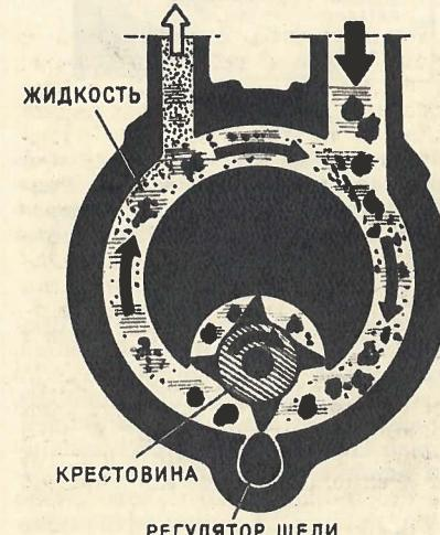
Коллоидная мельница. При вращении крестовины со скоростью до 10—12 тыс. об/мин в жидкости возникают гидравлические удары и разрывы — кавитация, измельчающая материал. Наличие жидкости, препятствующей смыканию микротрешины, способствует разрушению.
