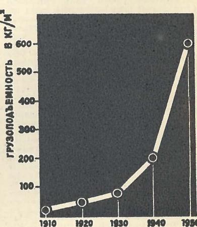
Рост удельной нагрузки на 1 кв. м крыла самолета по годам.
