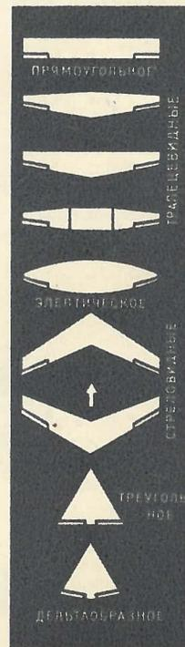
↑ Различные формы крыльев — от простейших прямоугольных первых самолетов до треугольных и дельтаобразных сверхзвуковых самолетов.
