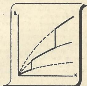
Условно этот процесс развития может быть изображен графически. Производительность каждой машины может расти за счет усовершенствований только до некоторого предела. Затем появляется принципиально новая машина, более совершенная, с которой происходит то же самое, и т. д. Развитие машин идет по «ступеням» на графике. Ясно, что при таком развитии производительность предела иметь не может.
