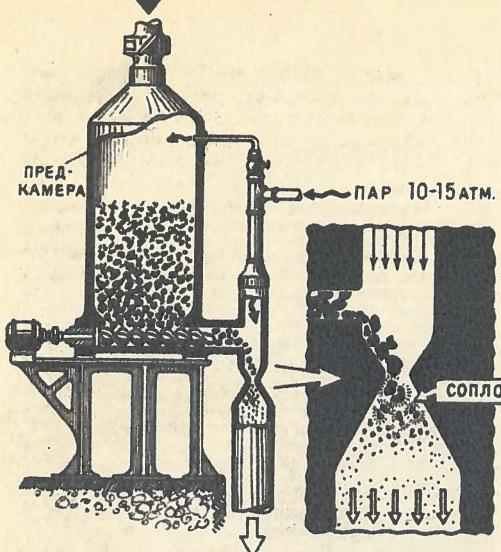
**Измельчение сбросом давления.** Частицы материала в предкамере насыщаются парами воды, проникающими в его трещины. При выходе в расширяющуюся часть сопла давление мгновенно падает и находящийся внутри частиц пар взрывает их, как маленькие бомбы.
