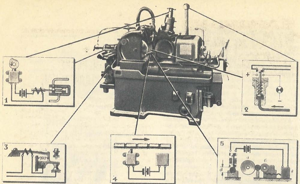
На фотографии показан бесцентровошлифовальный станок. Весь процесс обработки детали на нем происходит автоматически. Если шлифовальные круги «а» и «б» (фиг. 5) износятся и обрабатываемая деталь получится больших размеров, то тотчас же замкнутся контакты и устройство «в» подаст шлифовальный круг «б» вперед на величину износа кругов.
