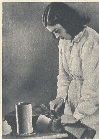
Определение влажности хлопка новым прибором.
