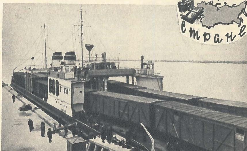
стоит из четырех дизелей по 900 л. с., четырех генераторов по 675 квт и двух гребных электродвигателей по 1 500 л. с. каждый. Схема привода: дизель — генератор — гребные электродвигатели. Для внутреннего обслуживания имеются отдельные вспомогательные генераторы и дизели. Прочность корпуса судна проверена в условиях ледового плавания. Его непотопляемость сохра-
