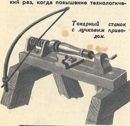
Токарный станок с ложковым приводом.
