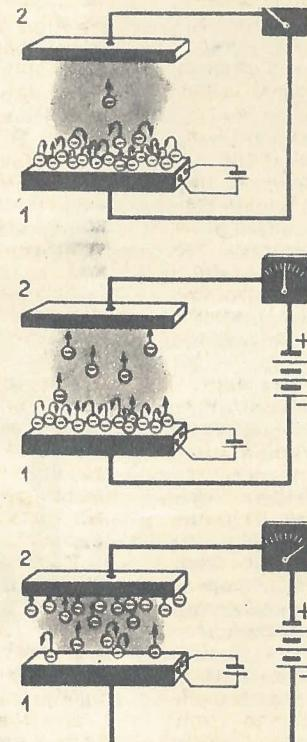
Упрощенная схема механически управляемого диода. Накаленный катод 1 испускает электроны. На верхнем рисунке показано непосредственное соединение катода 1 с анодом 2. При этом анодный ток оказывается ничтожно малым. На двух нижних рисунках изображена работа датчика. В анодную цепь его включена батарея. При сближении анода и катода анодный ток возрастает.
