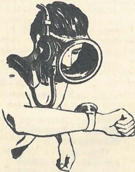
Водонепроницаемый футляр для часов или компаса. Глубомер.
