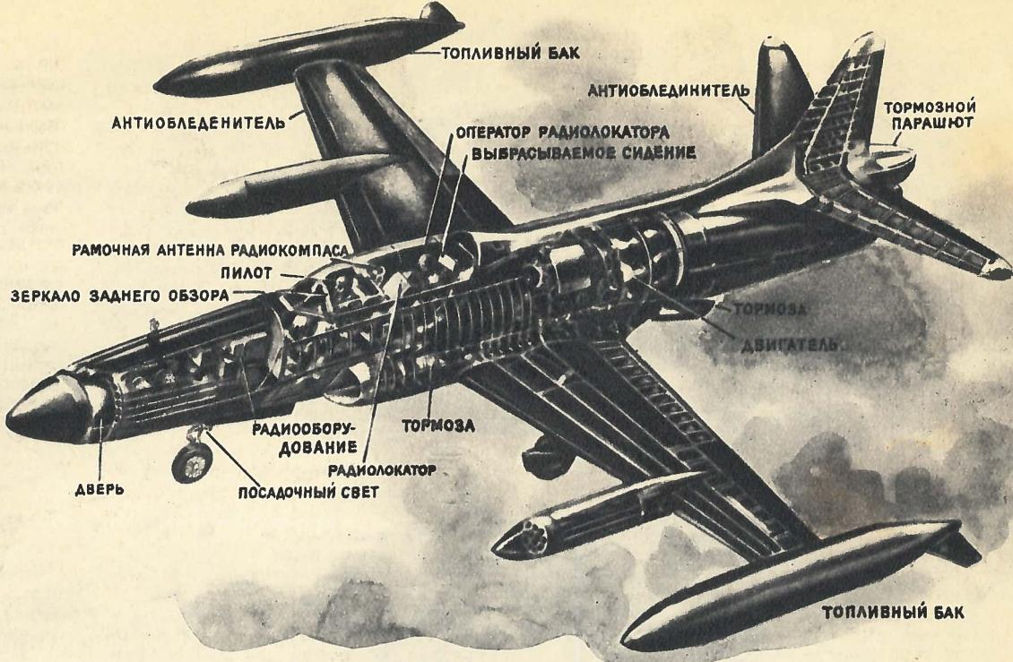
Разрез современного скоростного самолета и его основные устройства.
