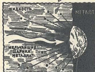
Эрозионное измельчение. Электрическая искра испаряет часть металла с поверхности пластинки. Пары металла конденсируются в жидкости в виде мельчайших шариков.
