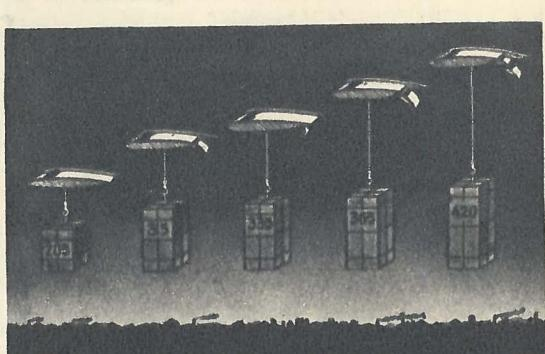
Рост грузоподъемности 1 кв. м площади крыла при скорости полета в 160 км/час в зависимости от усовершенствования «механизации» крыла — различной формы закрылок, и рост грузоподъемности по годам.
