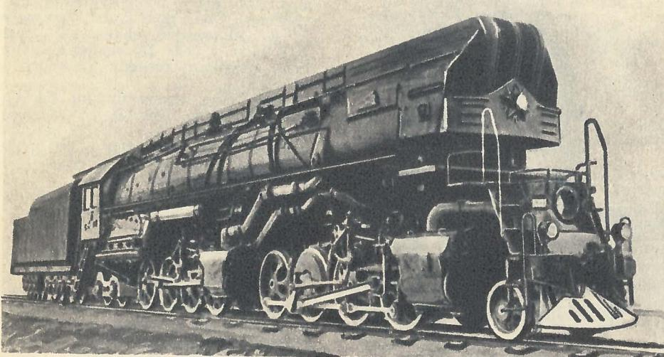
4100 л. с. достаточна, чтобы водить составы весом по 3 000—3 200 т. Это в полтора-два раза больше, чем водят магистральные товарные паровозы серии «Л», широко распространенные на наших железных дорогах. Конструкционная скорость — 85 км в час.
