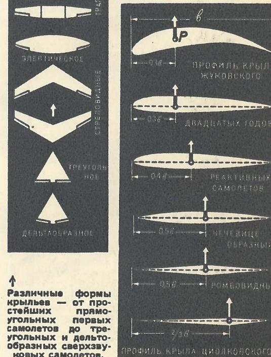
Различные формы крыльев — от простых прямоугольных первых самолетов до треугольных и дельтообразных сверхзвуковых самолетов.
