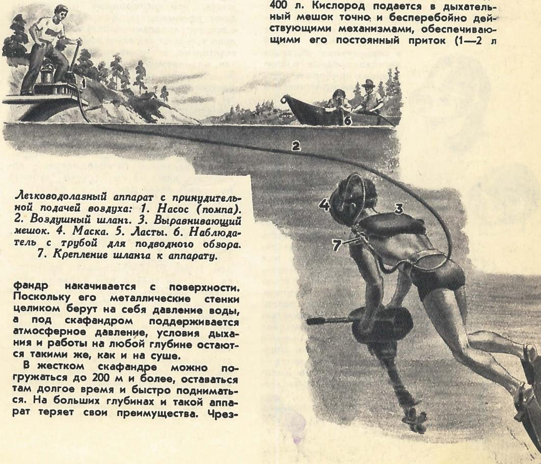
Легководолазный аппарат с принудительной подачей воздуха: 1. Насос (помпа). 2. Воздушный шланг. 3. Выравнивающий мешок. 4. Маска. 5. Ласты. 6. Наблюдатель с трубкой для подводного обзора. 7. Крепление шланга к аппарату.
