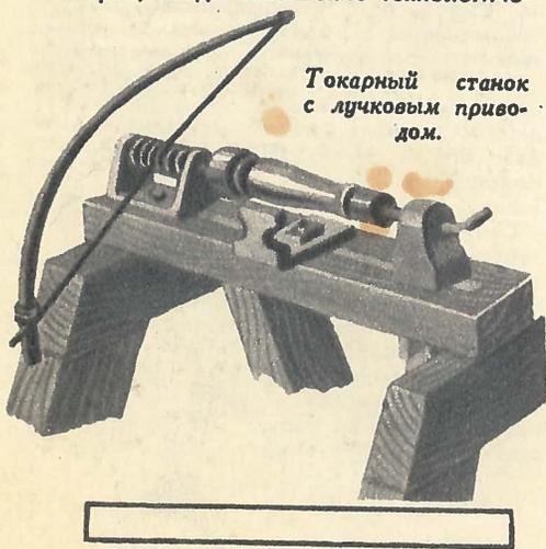
Токарный станок с лучковым приводом.
