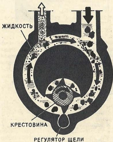
Коллоидная мельница. При вращении крестовины со скоростью до 10—12 тыс. об/мин в жидкости возникают гидравлические удары и разрывы — кавитация, измельчающая материал. Наличие жидкости, препятствующей смыканию микротрещин, способствует разрушению.
