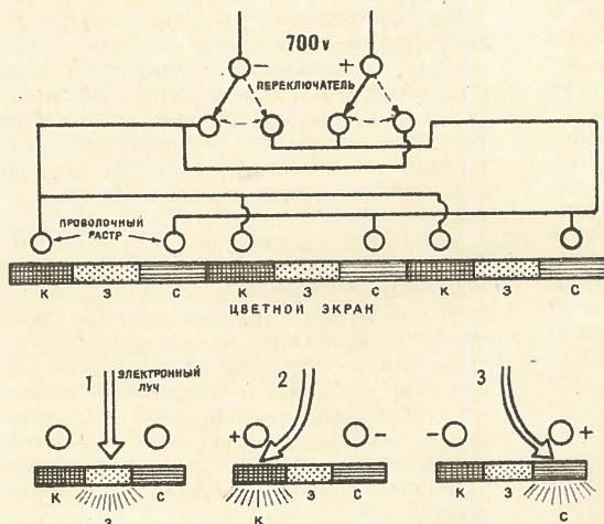
Рис. 3. Схема устройства цветной трубы, у которой один электронный луч, доходя до экрана, изгибается в сторону пластины, светящейся тем цветом, который в данный момент воспринимается передающей трубкой.
