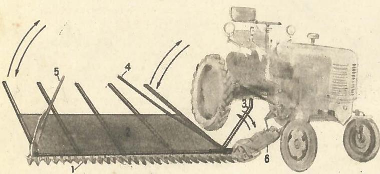
Приспособление к сено-косилке для уборки кукурузы: 1. Ножи сено-косилки. 2. Сбрасывающая подвижная платформа. 3. Педаль, поддерживающая платформу. 4. Внутренний направляющий прут. 5. Наружный направляющий прут. 6. Прицепное приспособление с валом отбора мощности.
