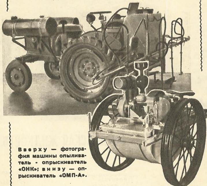
Вверху — фотография машины опыливатель-опрыскиватель «ОНК»; внизу — опрыскиватель «ОМП-А».
