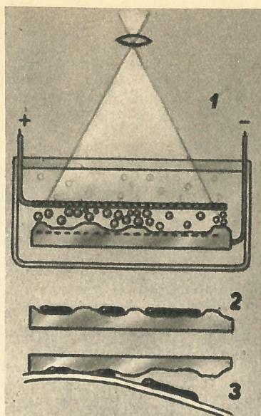
Электрическая фотография профессора Пильчикова. На катоде гальванической ванны получается рельеф, соответствующий изображению (1), затем в углублениях втирается краска (2) и изображение печатают на бумагу (3).
