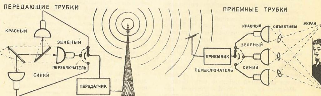
ку, светящуюся чисто белым цветом, перед которой вращается такой же, как и на передатчике, диск с тремя цветными фильтрами. Глаз зрителя видит передаваемое изображение тоже три раза: сначала через красный, потом зеленый, затем через синий светофильтры. Каждое из них при этом отличается от другого различной яркостью одних и тех же участков. Вследствие инерции глаза все эти три отдельных одноцветных, так называемых цветоделенных изобра-
