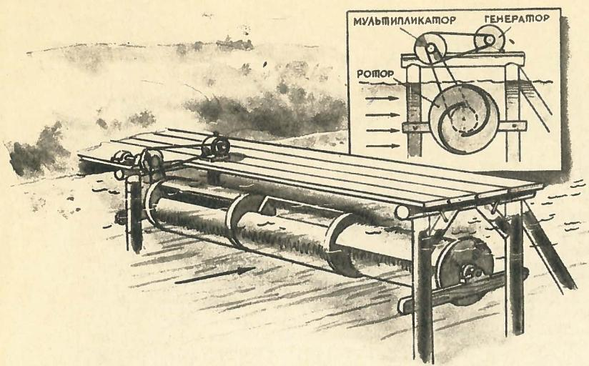
Один из типов бесплотинной электростанции с гидроротором.
