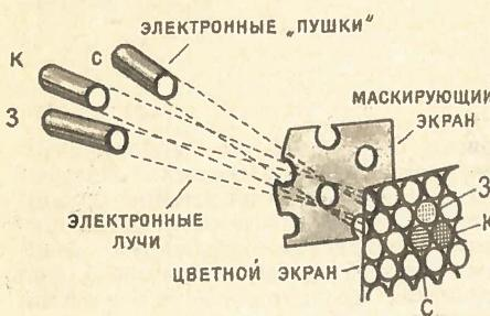
Рис. 2. Устройство экрана цветной трубы, использующей для развертки изображения три отдельных электронных луча.
