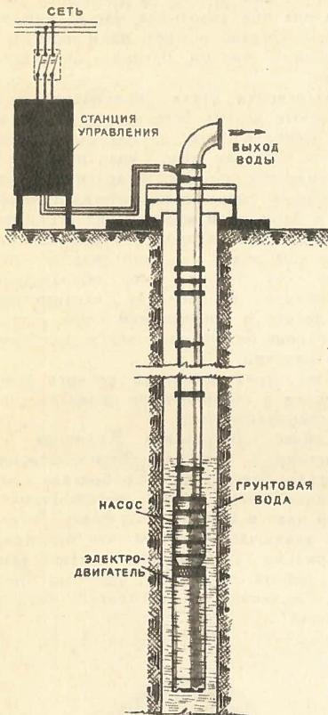
напряжением 380 в. Двигатель приспособлен для надежной работы в воде. Его обмотка из медной проволоки имеет водостойкую изоляцию, места соединений проводников изолированы липкой водостойкой лентой. Вращающиеся части — втулка и пята вала ротора — сделаны из нержавеющей стали. Вал стальной, подшипниковые щиты из чугуна, магнитопровод набран из штампованных листов электротехнической стали.
