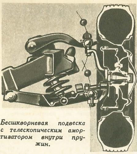
**Бесшворневая подвеска с телескопическим амортизатором внутри пружин.**
