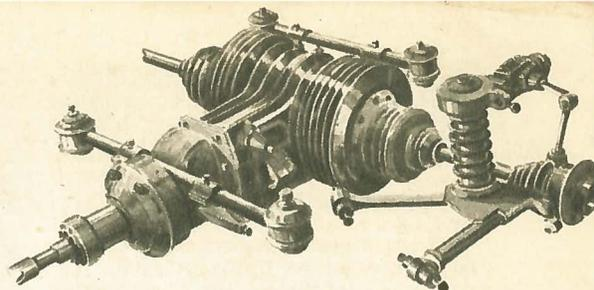
Задний мост с независимой подвеской колес, с тормозами и коробкой передач, укрепленными на картере заднего моста.
