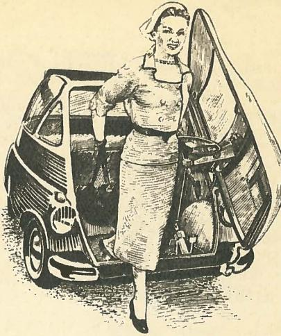
У автомобиля «изетта» дверца устроены в передней стенке.
