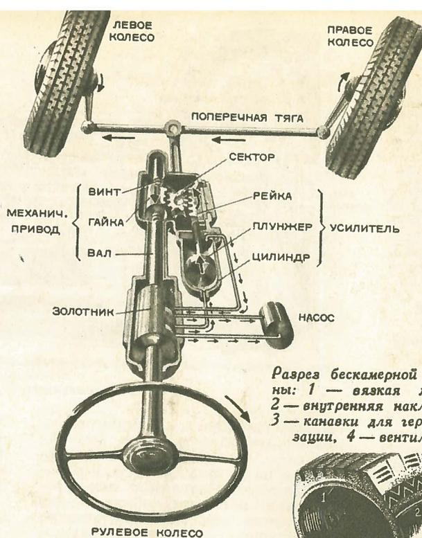
Схема гидравлического усилителя руля.
