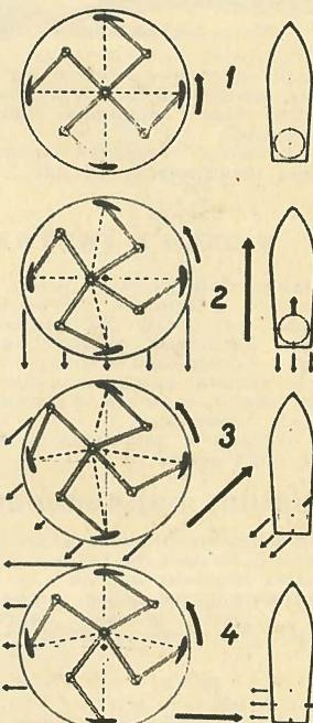
Положение лопастей движителя при движении судна вперед (1, 2) и его повороте (3, 4).
