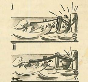
амортизатор для бортов лодки;
