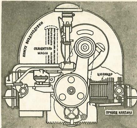
Двигатель с горизонтальными противоположными цилиндрами и воздушным охлаждением.
