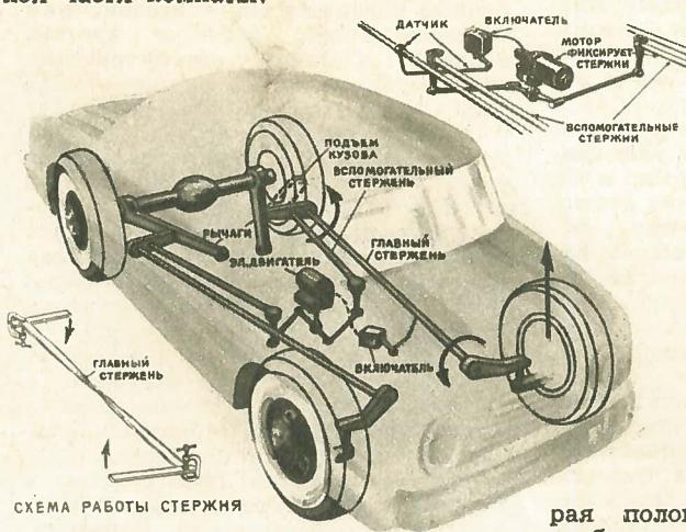
**Схема работы стержня.**
