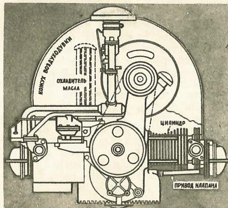
Двигатель с горизонтальными противолежащими цилиндрами и воздушным охлаждением.
