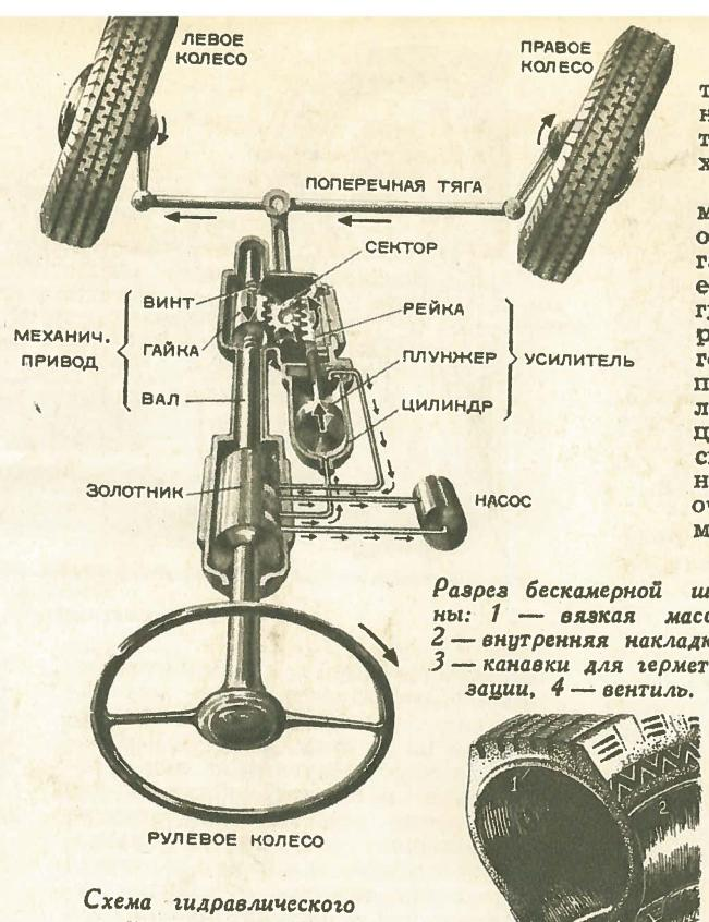
Схема гидравлического усилителя руля.
