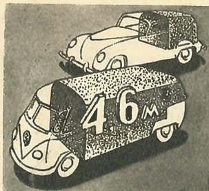
Сравнение обзорности, распределения веса по колесам, емкости «вагонного» и обычного автомобилей.
