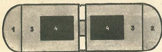
*Компоновка помещений электровоза постоянного тока. Из кабин машиниста (1 и 2) можно пройти в машинные отделения (3), а из них — в помещения высоковольтной аппаратуры (4).*
