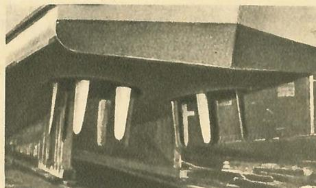
Судно с «циклоидальным» двигателем.
