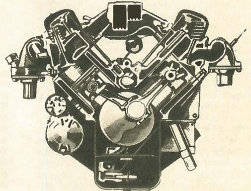
Поперечный разрез V-образного восьмцилиндрового двигателя с верхними клапанами.
