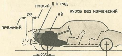
Укорочение автомобиля с применением V-образного восьмицилиндрового двигателя вместо шестицилиндрового однорядного.
