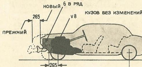
Укорочение автомобиля с применением V-образного восьмицилиндрового двигателя вместо шестицилиндрового однорядного.
