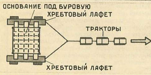
Для облегчения перевозки все буровое оборудование вместе с вышкой устанавливается на трех массивных металлических площадках — блоках. На первой площадке устанавливается вышка со всем оборудованием находящимся внутри нее, на второй — насосы и на третьей — глиномешалка, емкости и желобная система для глинистого раствора. Самый крупный блок весит 100 т, самый легкий — 40 т.
