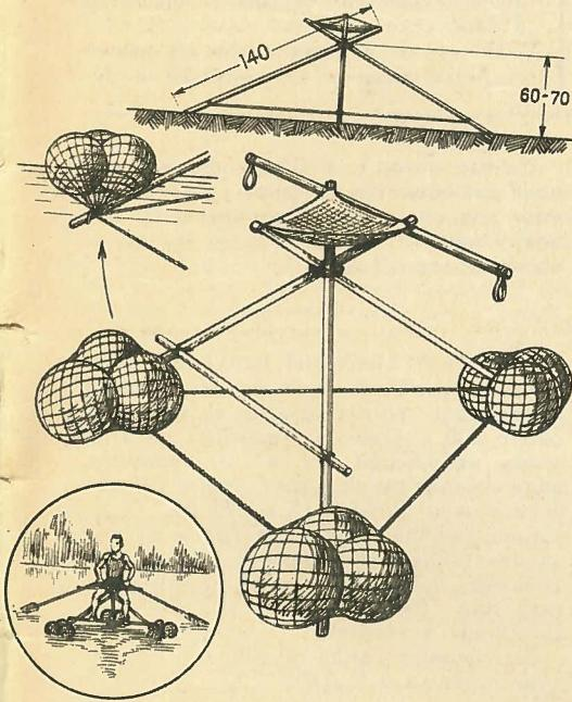
Шароплав напоминает складной треножный стул, плавающий на нескольких шарах — надутых баскетбольных камерах. Опоры его можно сделать из легких бамбуковых палок или тонких жердей диаметром 3—5 см. Их соединяют между собой растяжками из веревок.
