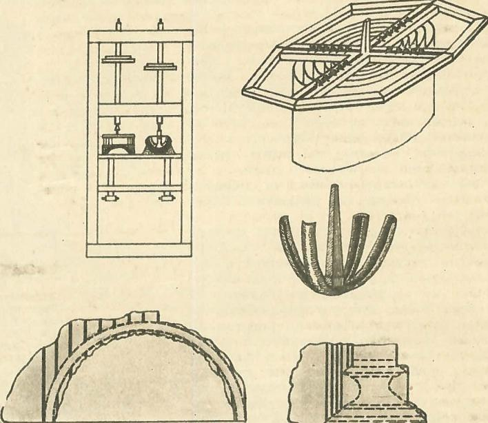
Смочив сверла, терку и поверхность камня смесью воды и наждачка, приводили в движение валы с этими инструментами, и обработка изделия начиналась. После того как долотами удаляли камень, оставшийся между канавками, для шлифования и полирования обрабатываемой поверхности меняли железные терки на медные, а затем на оловянные.
