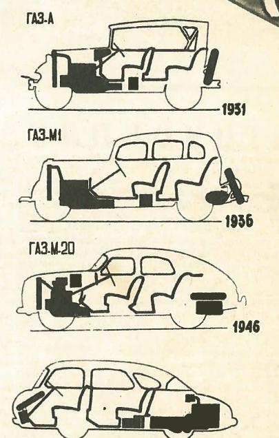
Компоновка автомобиля развивается в направлении увеличения использования пространства, форма — в направлении улучшения обтекаемости.
