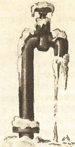
рое она может замерзнуть — в надземной части трубы образуется ледяная пробка. Дайте проект колонки, которая бы не замерзала.
