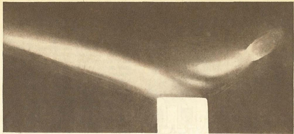
Электрическая дуга высокой интенсивности, снятая в момент, когда положительный электрод (уголь) начинает плавиться и из дуги вырывается длинный факел пламени, содержащий испарившийся углерод и вещества, примешанные к электроду. Температура дуги может достигать  $10000^{\circ}\text{C}$ .
