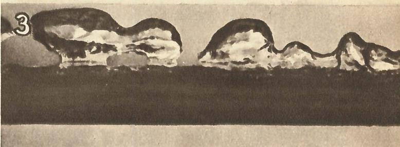
В результате работы Нукияма и других последующих исследований пришли к выводу, что существуют две формы кипения: пузырьковое — протекающее при температуре нагретой поверхности до  $125^{\circ}$  (для воды), и пленочное, когда температура поверхности превышает  $250-300^{\circ}$ .
