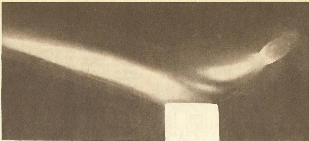
Электрическая дуга высокой интенсивности, снятая в момент, когда положительный электрод (уголь) начинает плавиться и из дуги вырывается длинный факел пламени, содержащий испарившийся углерод и вещества, примешанные к электроду. Температура дуги может достигать 10000°C.
