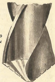
Рис. 6. Сверло со стружколомательными канавками.
