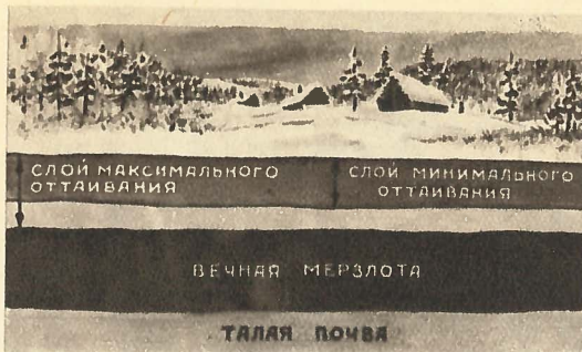
Схематический разрез мерзлых и талых слоев.
