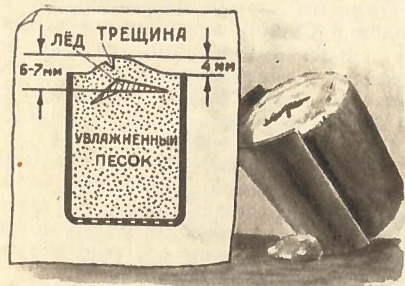
Увлажненный песок, замороженный в стакане в лабораторных условиях, приобретает на поверхности наледный бугор с трещинами, а внутри бугра — линзу льда.
