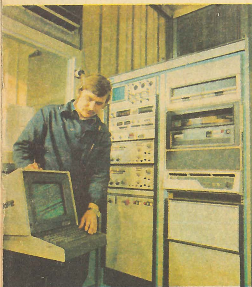
Пульт управления вибростендом, который работает по изменяемой программе.
